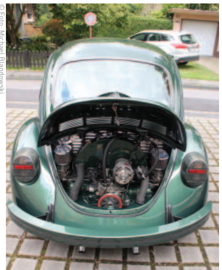
Legendär und einzigartig: der Boxermotor im VW Käfer ist selbstverständlich hinten.
